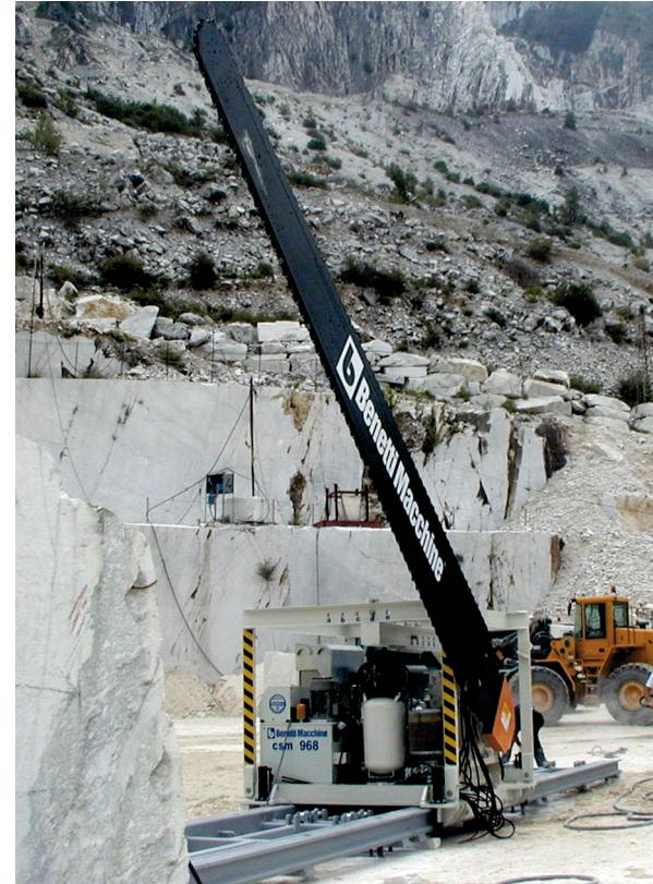
La cortadora de cadena Modelo CSM 968 puede efectuar cortes verticales hasta la profundidad máxima de 8,00 metros y cortes horizontales hasta 4 metros en mármol, caliza y piedras similares. Nuestra firma ofrece al cliente la posibilidad de montar en la máquina las siguientes cadenas para optimizar las prestaciones de corte en diferentes materiales:
