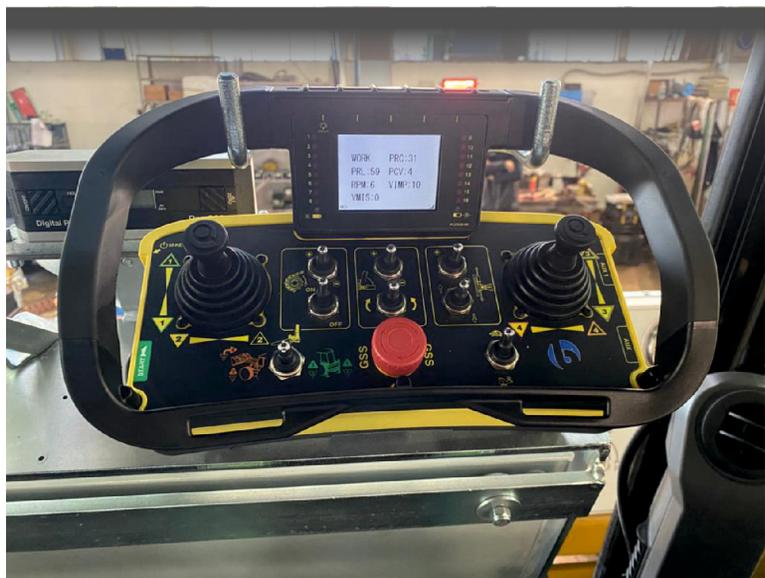
Radiocomando per il posizionamento e lavoro del sistema di taglio.
