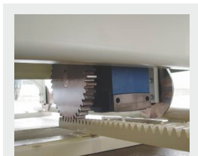
Sistema ingranaggio-cremagliera per traino Rock-pinion transmission
