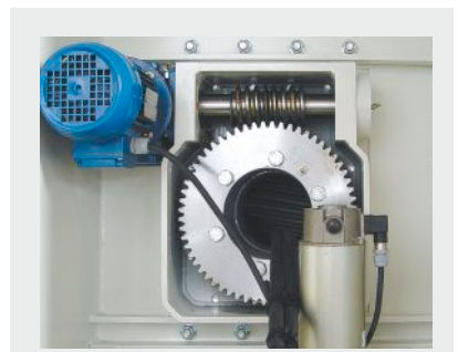
Sistema rotazione testa operatrice Driving unit rotation gears
