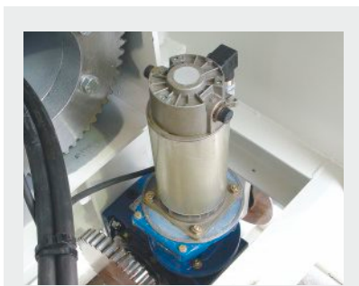
Motore c.c. per traino D.C. transverse motor
