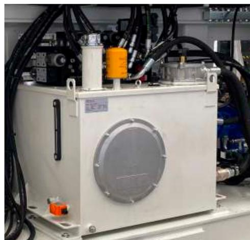
Particolare della centralina idraulica e della motopompa principale
