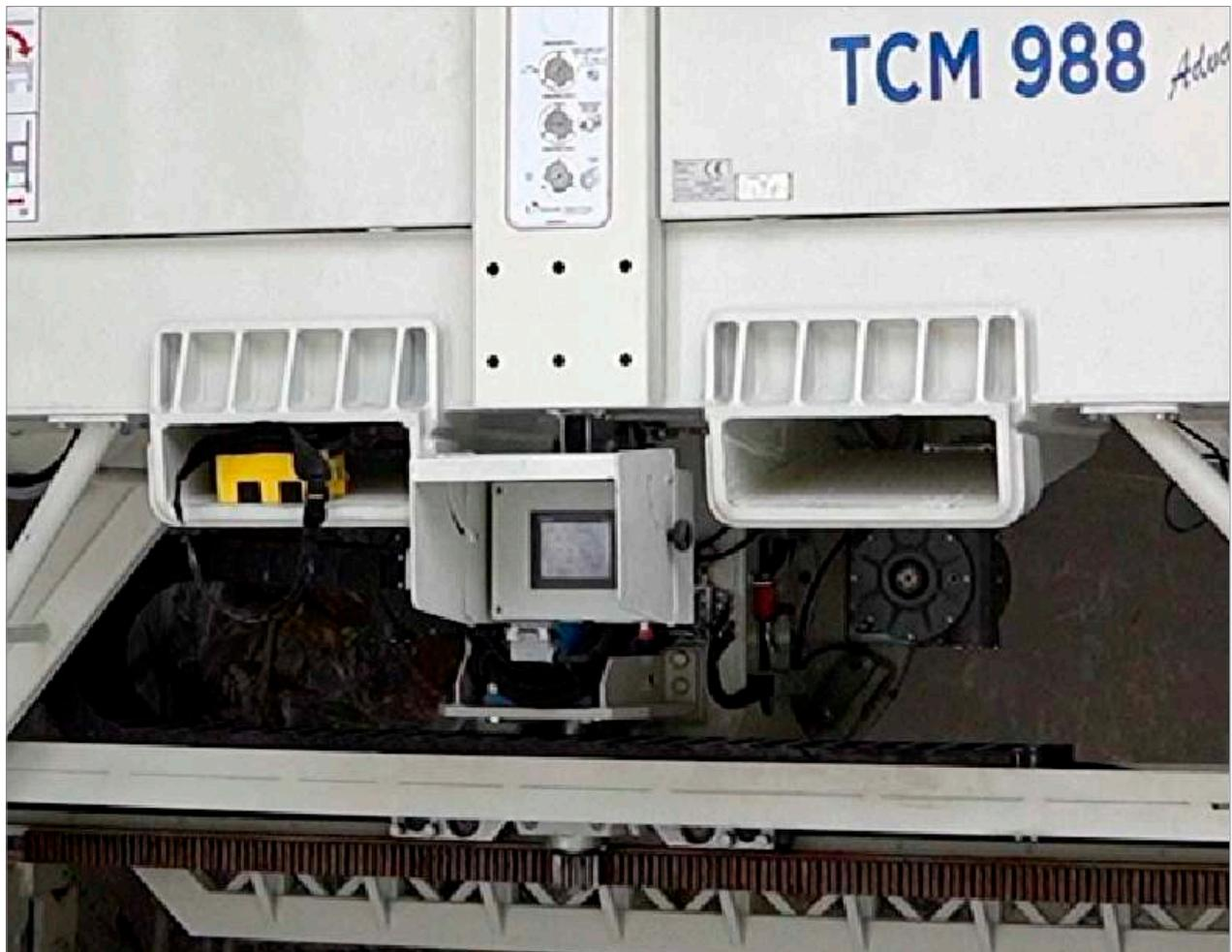
Per rendere funzionante la macchina è sufficiente collegare per mezzo di una presa da 125 A una linea elettrica 400 Volt 50 Hz circa 65 kW da inserire nell'apposita spina a bordo macchina.
